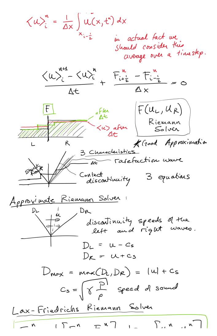
$$F_{i-\frac{1}{2}} = \frac{1}{2} \left[ F_i^n + F_{i-1}^n \right] - \frac{1}{2} D_{max} \left[ U_i^n - U_{i-1}^n \right]$$
